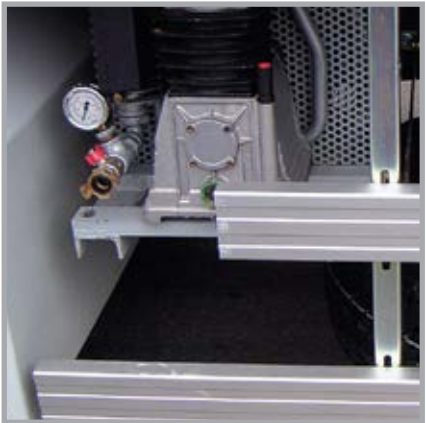
Kostengünstiger Kompressor mit 455 l/min und 12 bar Druck – dank kompakter Maße hinter dem seitlichen Unterfahrschutz montiert
