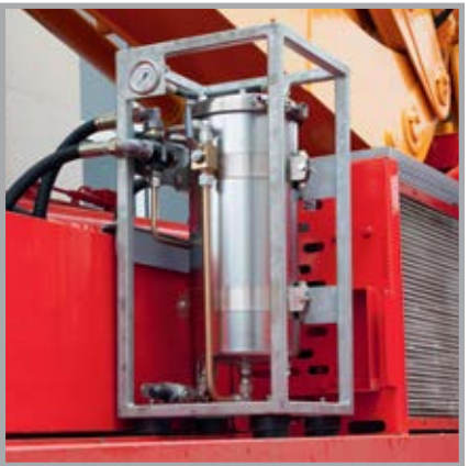
Der mobile Nebenstromfilter verlängert Standzeiten und spart Ölwechsel
