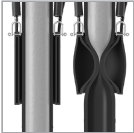
Das pneumatisch betätigte Endschlauch-Verschlußventil (EQV) unterbricht den Betonfluss und verhindert ein Nachtropfen
