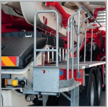
Die ergonomische Arbeitsplattform (optional) mit rutschhemmender Oberfläche bietet viel Platz für den Maschinisten
